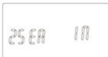
2. SEN: Выбор датчика. С помощью кнопок + и - выберите режим работы 1N : датчик воздуха; OUT: датчик пола, ALL: оба датчика (датчик пола ограничительный). Нажмите “
