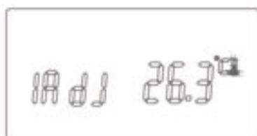
1. ADJ: Калибровка температуры. С помощью кнопок + и - откалибруйте температуру. Предел калибровки  $\pm 9,9^{\circ}\text{C}$ , нажмите “
