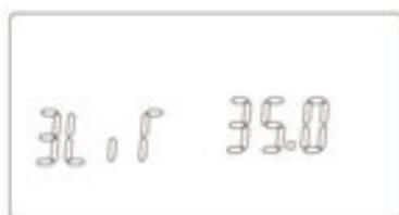
3. LIT: Ограничение температуры пола. С помощью кнопок + и - установите для ограничения максимальную температуру для пола. Предел ограничения  $5-60^{\circ}\text{C}$ . Нажмите “
