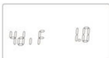
4. DIF: Шаг регулировки температуры. с помощью кнопок + и - установите шаг регулирования температуры. Диапазон  $0,5-10^{\circ}\text{C}$ . Нажмите “
